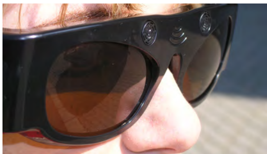
Obrázek č. 53 – Ultrazvukové brýle
