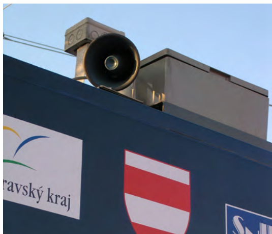
Obrázek č. 33 – Orientační majáček na dopravním prostředku
