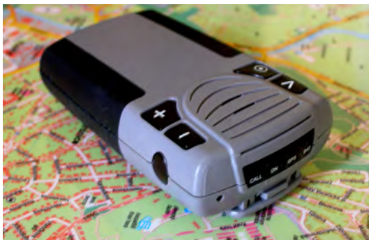
Obrázek č. 58 – Navigační jednotka pro nevidomé
