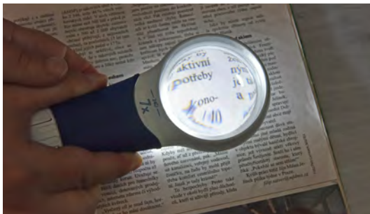
Obrázek č. 82 – Ruční lupa s rukojetí a osvětlením
