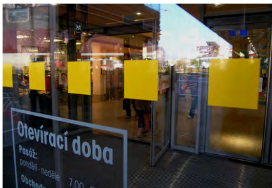
Obrázek č. 43 – Vzorové řešení označení prosklených ploch
