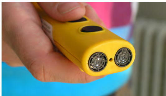
Obrázek č. 52 – Ultrazvukový vyhledávač překážek do ruky
