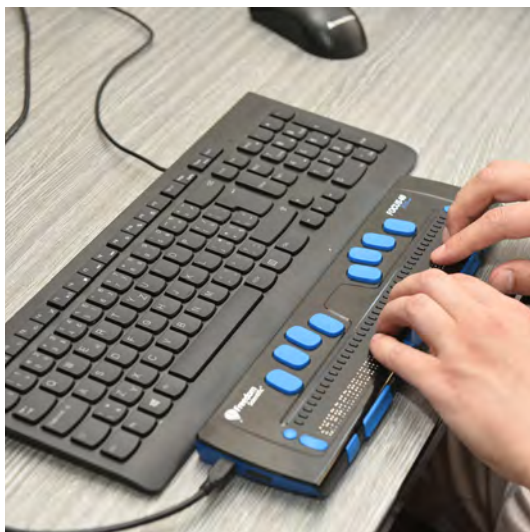
Obrázek č. 61 – Digitální čtecí přístroj – stolní provedení
