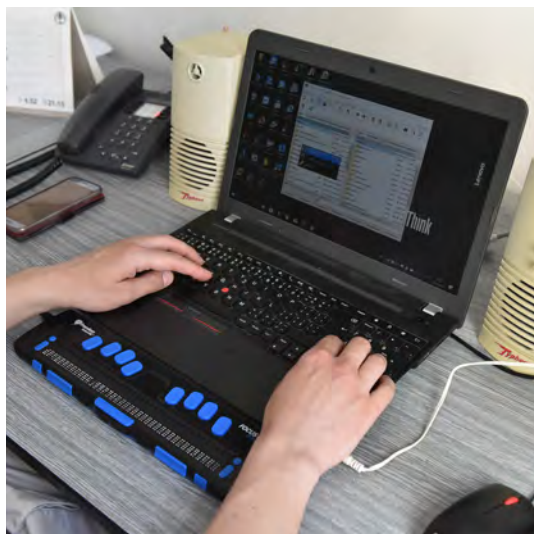
Obrázek č. 62 – Digitální čtecí přístroj – přenosné provedení
